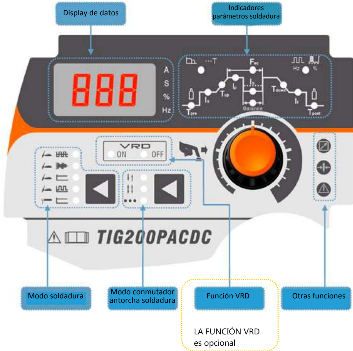
Fig. 8-3 Descripción de las funciones del panel
