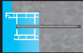
Ø 6,5 fijación con tornillos para hormigón
